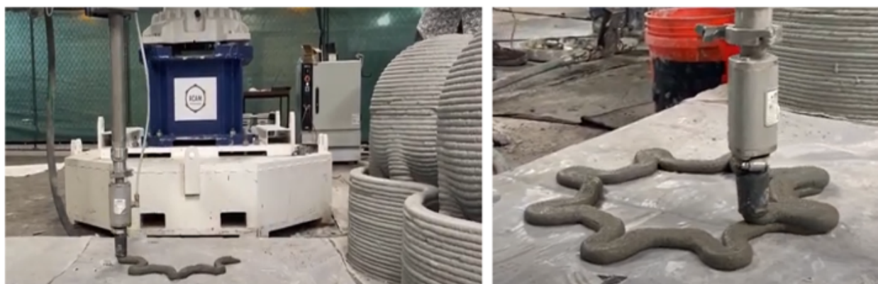
Figura 19: Impressão 3D de componentes de concreto para estruturas offshore
