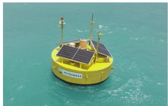
Figura 9: Boia remota de avaliação de ventos offshore (Bravo)
